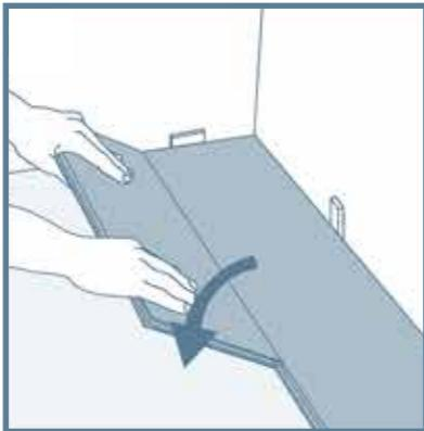
Verlegen Sie die Platte im Winkel gegen die Platte in der vorherigen Reihe, drücken Sie nach vorne und biegen Sie sie gleichzeitig nach unten.
